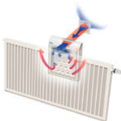
Figur 15 Ytterveggsv ventil for montasje bak varmekilde. Dysene stilles manuelt for å få riktig fordeling over varmekildens overflate.
