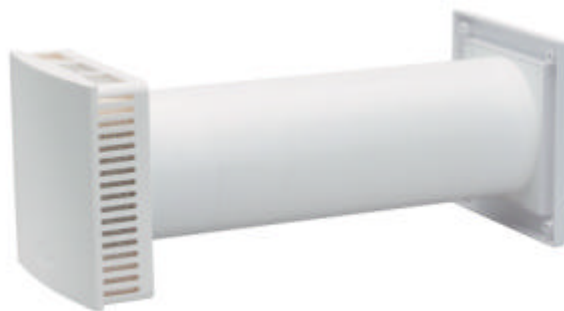
Figur 11 Fresh 90-dB. Yttervegsventil med gunstig strømningsmønster som reduserer trekkrisiko (klarer opp til 8 l/s ved -20^{\circ}\text{C} uten trekk). Integrert filter (flere filtervalg) og lydreduksjon, og kondensbeskyttelse. Kan innjusteres med minimum-åpning slik at den ikke kan stenges helt. Luftkapasitet 9 l/s ved 10 Pa.
